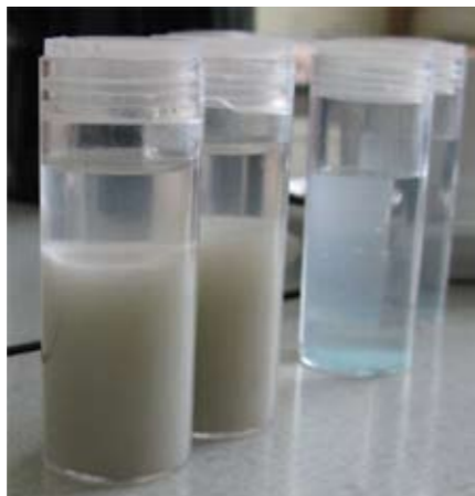
Foto1: De twee eerste flesjes op de foto links bevatten vloeibare CO 2 en op de foto rechts (foto 2) ziet u vaste CO 2 . Het derde flesje bevat vloeibare methaan en het blauwe bezinsel is methaan in vaste toestand.
